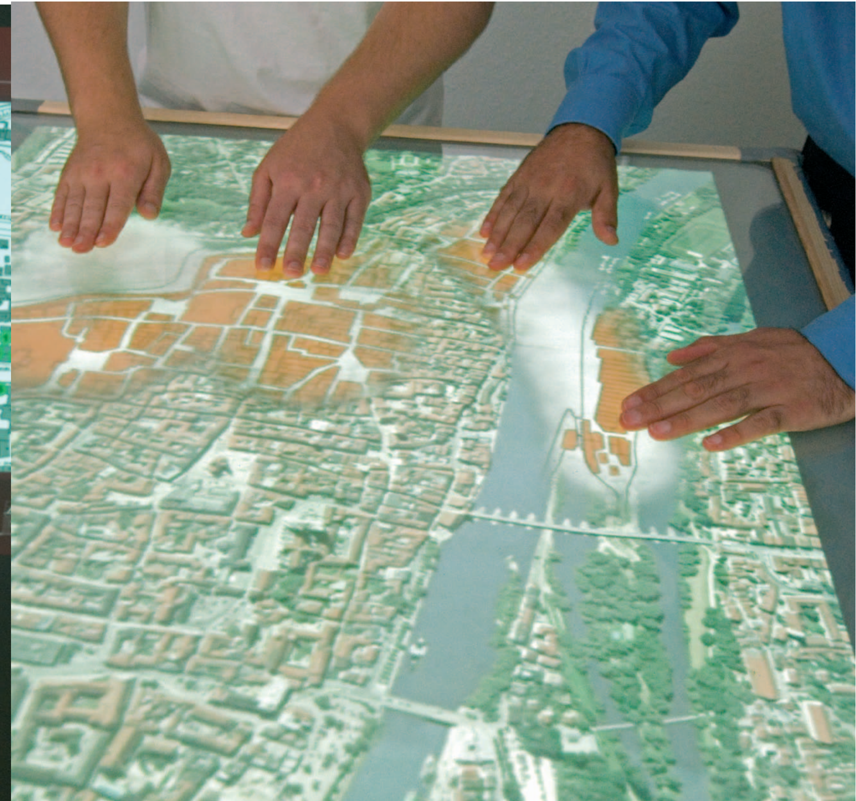
Bild 8: Ein Prototyp des TimeWindow- Exponats, konstruiert von Doktorand David Holman. Durch Wischbewegungen können Benutzer sich durch die bauhistorischen Schichten einer Karte der Regensburger Altstadt graben und so die Bauentwicklung der Stadt seit der Römerzeit erforschen. Eine Besonderheit: Das System läßt mehrere Besucher gleich- zeitig mit der Karte interagieren.
