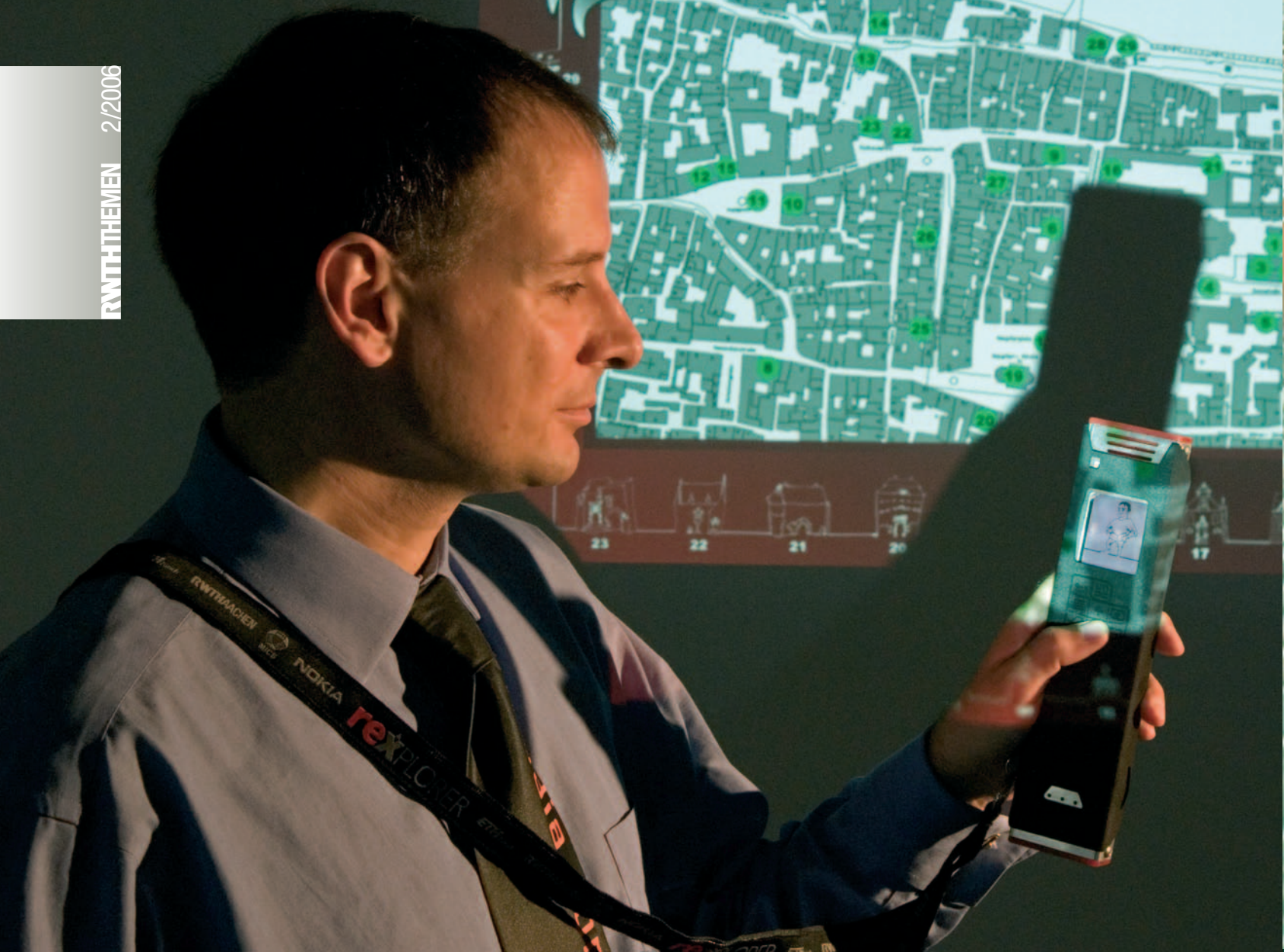
Bild 7: Prof. Borchers mit dem REXplorer-Detektor. Das Gerät enthält ein Handy und Navigationssystem und kann auf Gesten reagieren, um in Regensburgs Altstadt mit historischen Figuren Kontakt aufzunehmen.
